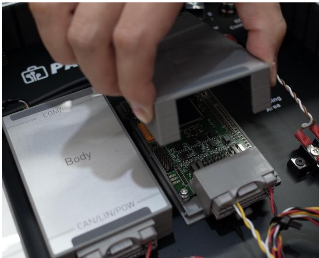
図 4.2 ECU のカバーを取り外す様子
